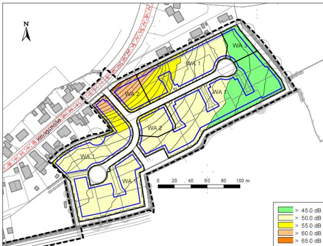
Abbildung 11: maßgeblicher Außenlärmpegel für schutzbedürftige Räume gemäß Abbildung 1 schalltechnische Untersuchung; Quelle: LAIRM CONSULT GmbH
