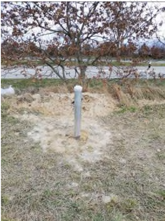
Abb. 6: GWM 02 im Nordosten der Altlandlagerung an der B203
