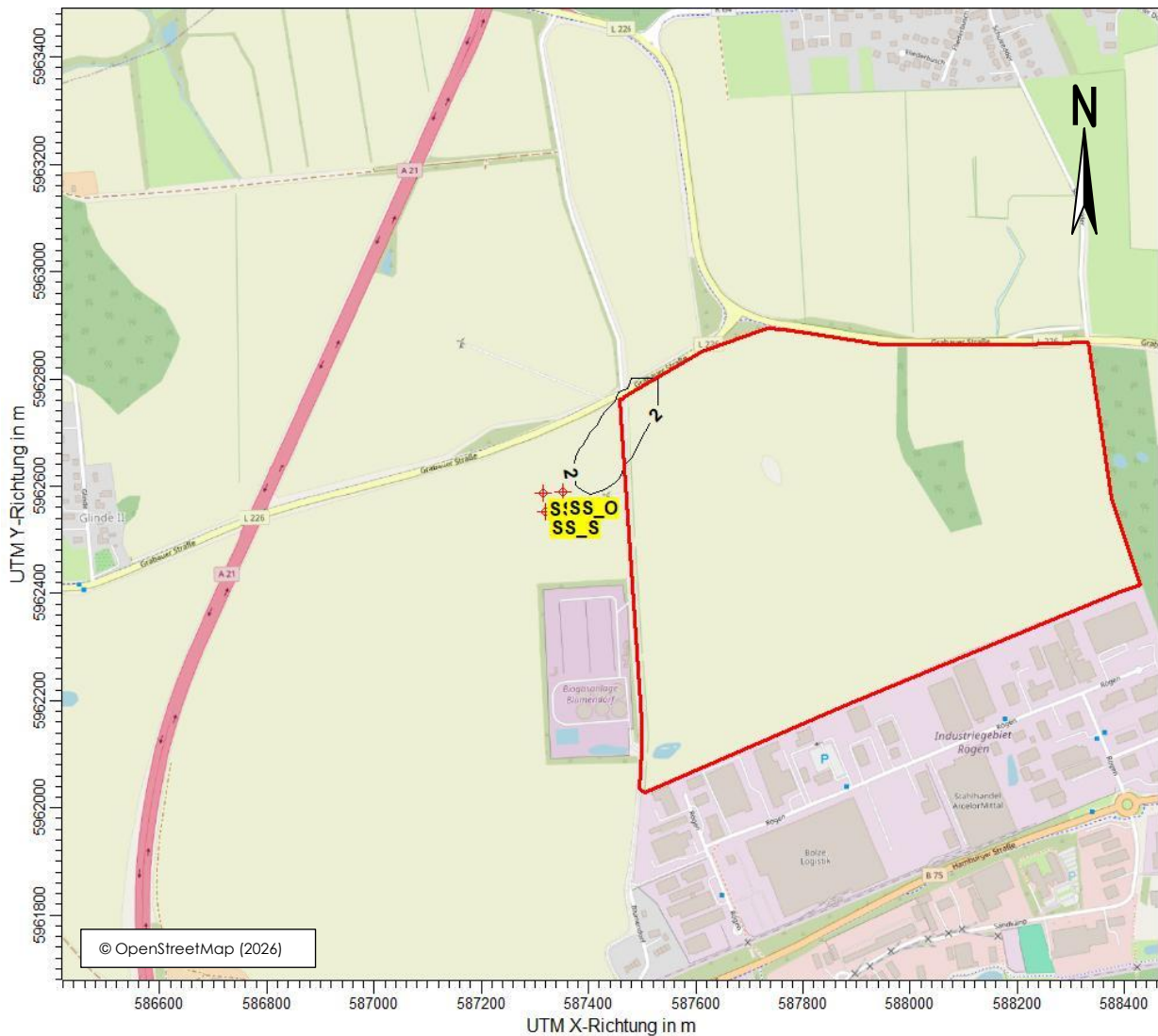
Abbildung 5: Gesamtzusatzbelastung IGZ durch den Betrieb der geplanten Heizzentrale in % der Jahresstunden, Isoliniendarstellung
