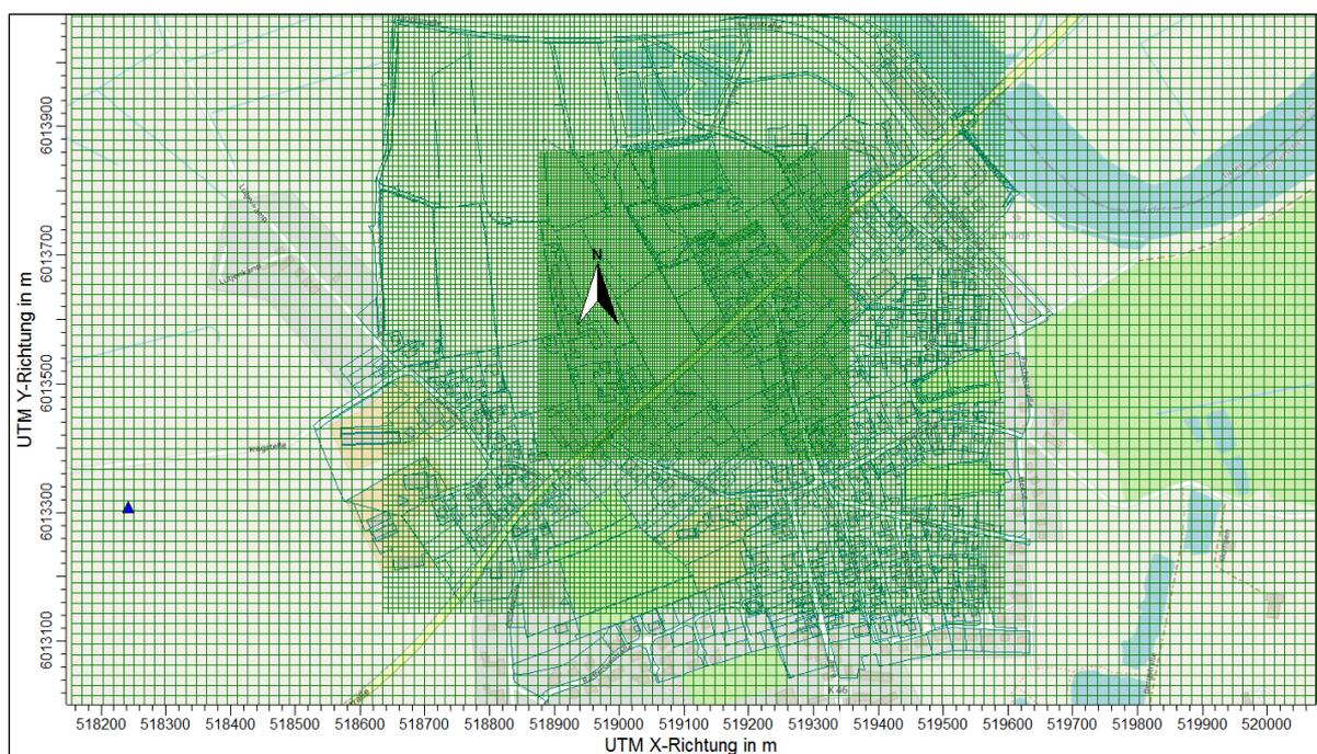
Abbildung 6.5: Rechengitter und Lage Ersatz-Anemometer-Position (Dreieck)
