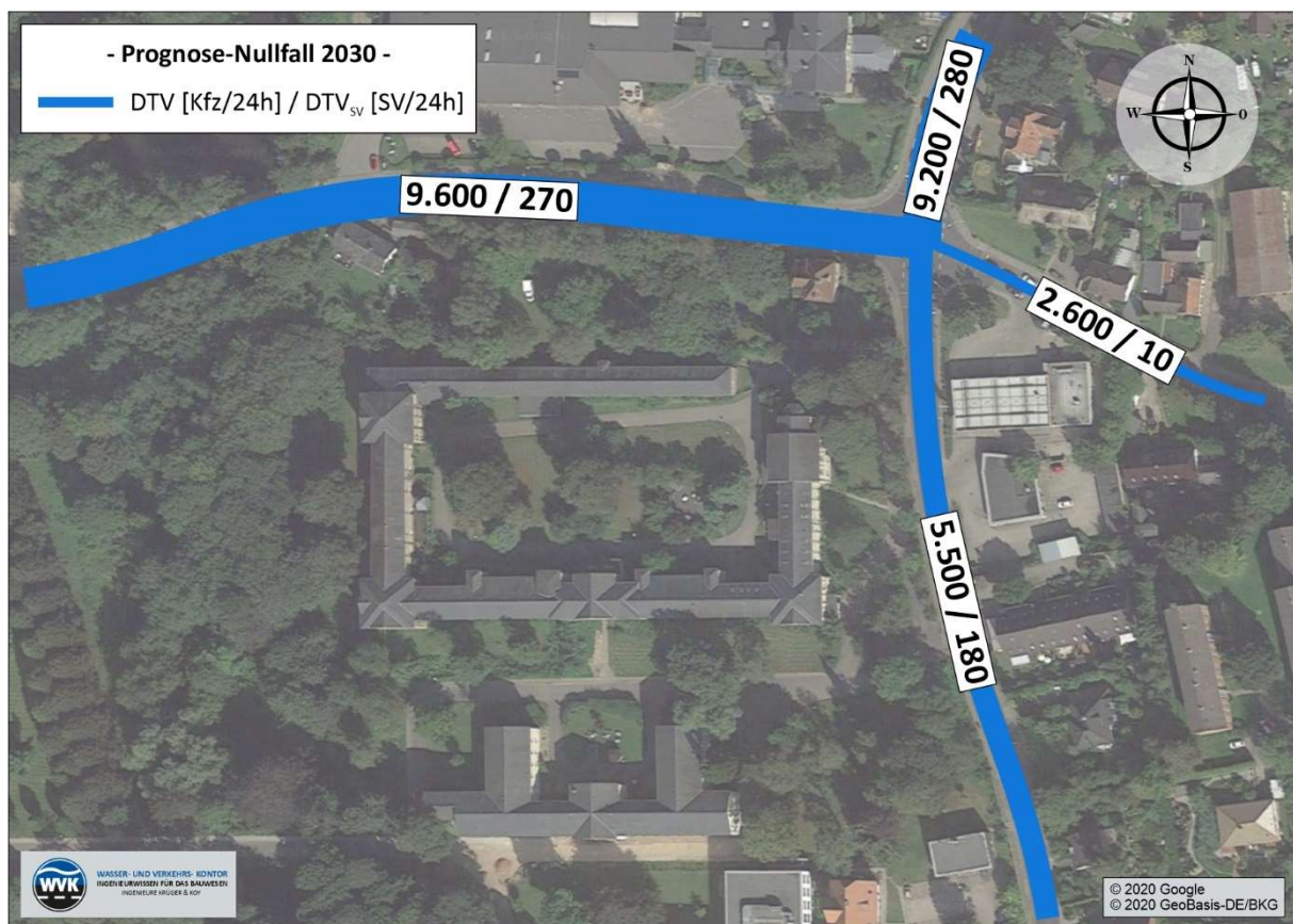
Abbildung 3.3: Prognose-Nullfall 2030 – Durchschnittliche Tagesverkehrsstärke (DTV, DTV SV )
