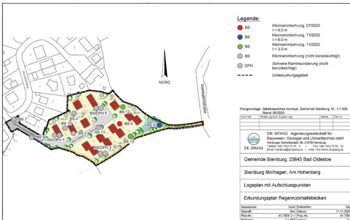
Abbildung 12: Lageplan mit Aufschlusspunkten – Erkundungsplan Regenrückhaltebecken (Dr. Spang Ingenieurgesellschaft für Bauwesen, Geologie und Umwelttechnik mbH)
