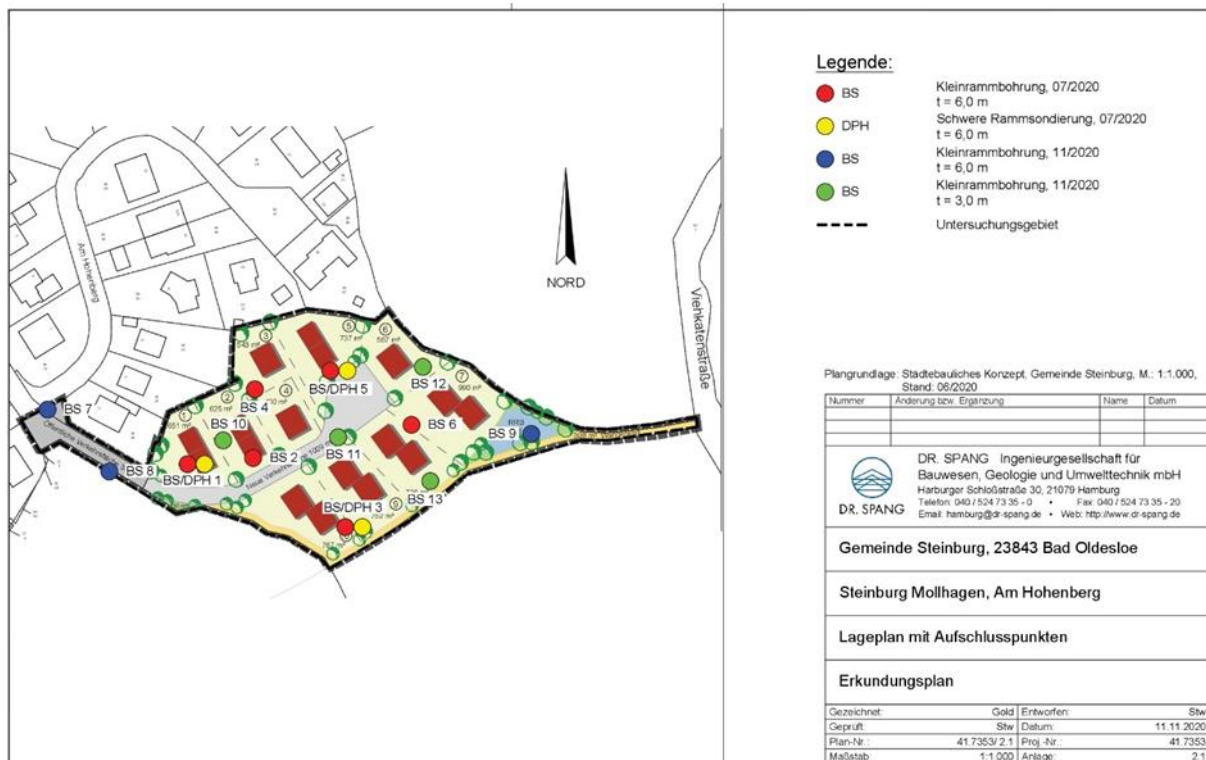
Abbildung 12: Lageplan mit Aufschlusspunkten - Erkundungsplan (Dr. Spang Ingenieurgesellschaft für Bauwesen, Geologie und Umwelttechnik mbH)
