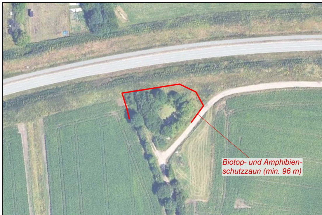
Abb. 3: Ungefähre Lage der bauzeitlichen Schutzmaßnahmen für den Kammmolch während des Lärmschutzwall-Rückbaus (Maßstab 1:1.500)
