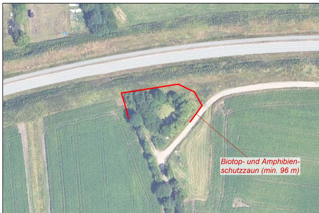
Abb. 2: Ungefähre Lage der bauzeitlichen Schutzmaßnahmen für den Kammmolch während des Lärmschutzwall-Rückbaus (Maßstab 1:1.500)
