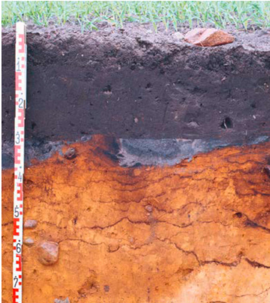
Abbildung 14 – Aufbau / Systemquerschnitt eines Podsol – Braunerde-Bodenprofils
