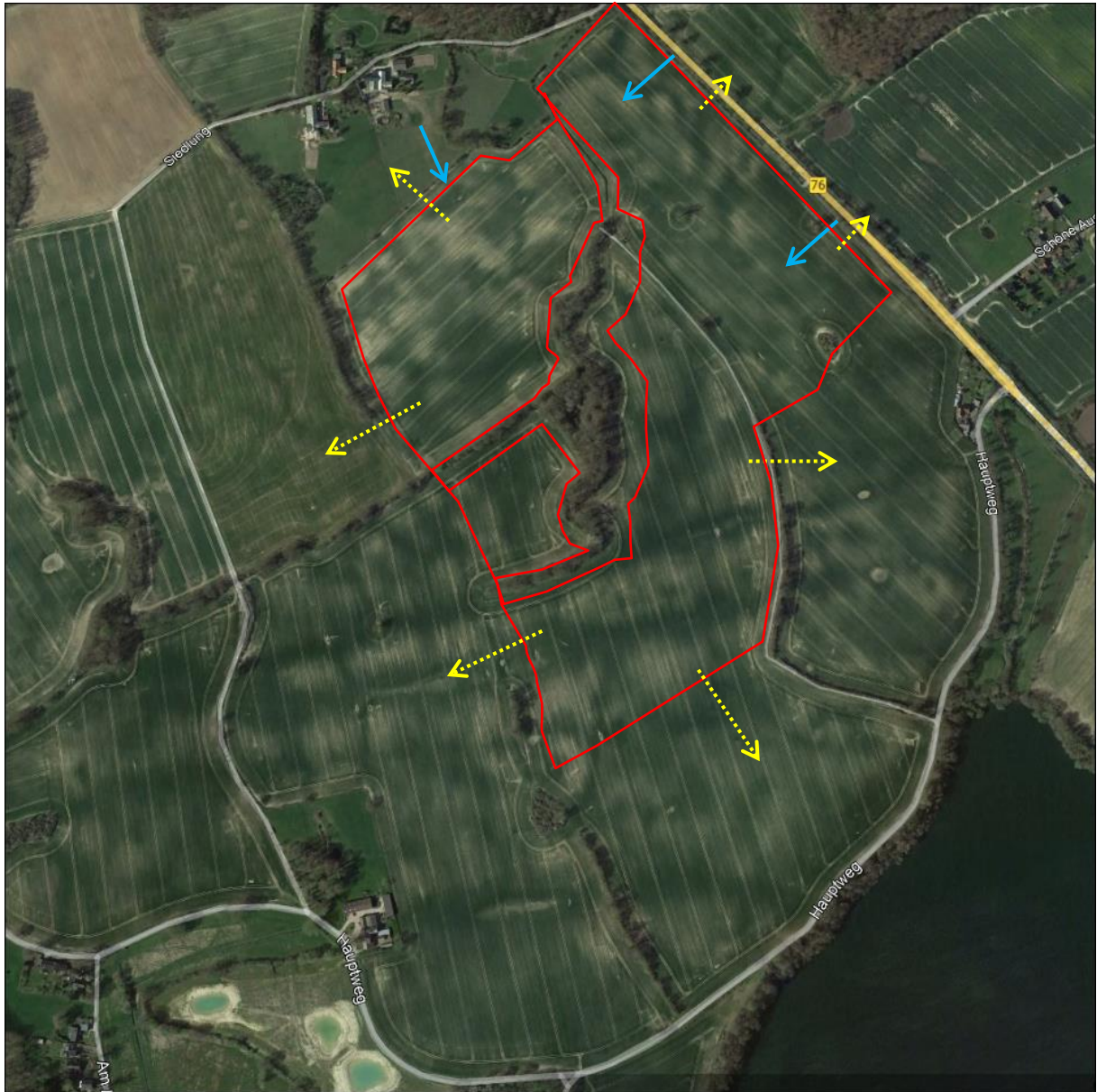
Abb. 4: Flächeninanspruchnahme und Wirkräume der zu erwartenden Wirkfaktoren (Lärm und optische Einflüsse während der Bauphase, PV-Anlage in Betriebsphase, Pfeillänge (max. 150 m) entspricht dem Wirkungsbereich).
