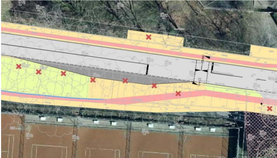
Abbildung 13: Lageplan verlegte Haltestelle und Busspur (SBI)
