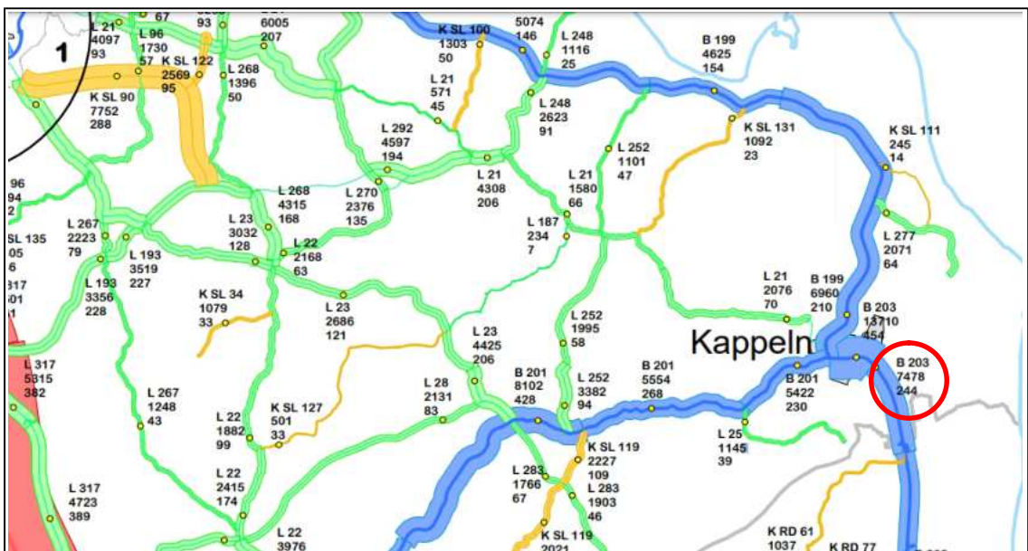
Bild 2: Vorhandene Verkehrsbelastungen B 203 gem. Verkehrsmengenkarte SH
