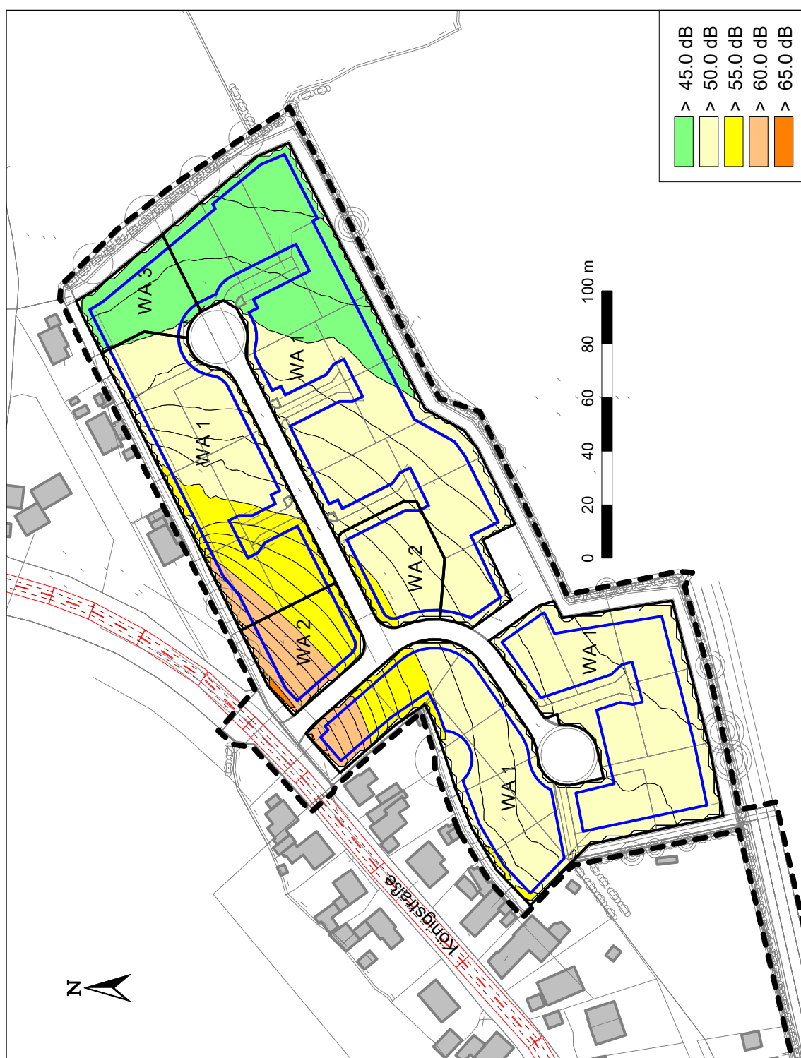
Abbildung 1: maßgeblicher Außenlärmpegel für schutzbedürftige Räume
