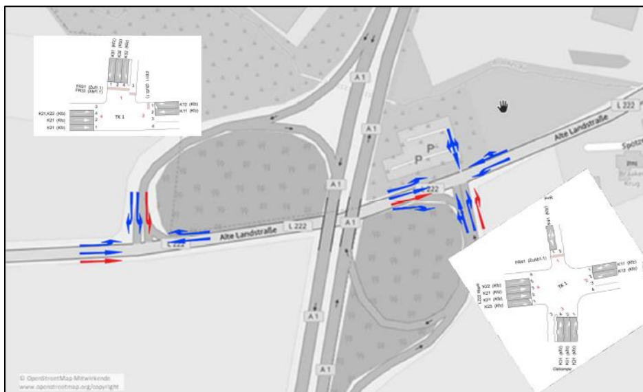
Abbildung 6: Struktur AS Stapelfeld mit Spurverdopplung aus Hamburg kommend, Quelle: Verkehrskonzept M+O Ingenieurgesellschaft für das Bauwesen mbH
