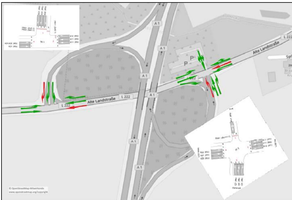
Abbildung 7: Struktur AS Stapelfeld mit Spurverdopplung nach Hamburg fahrend, Quelle: Verkehrskonzept M+O Ingenieuresellschaft für das Bauwesen mbH
