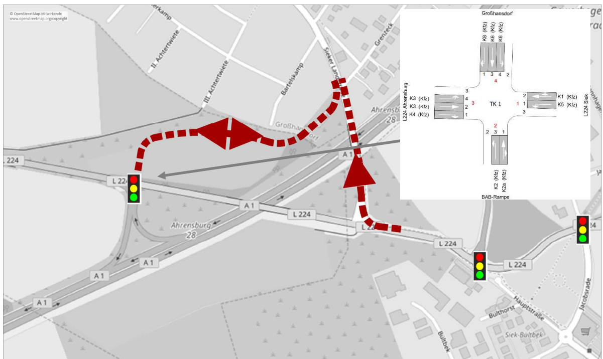
Abb. 15: AS Ahrensburg, Verlegung Anbindung Großhansdorf
