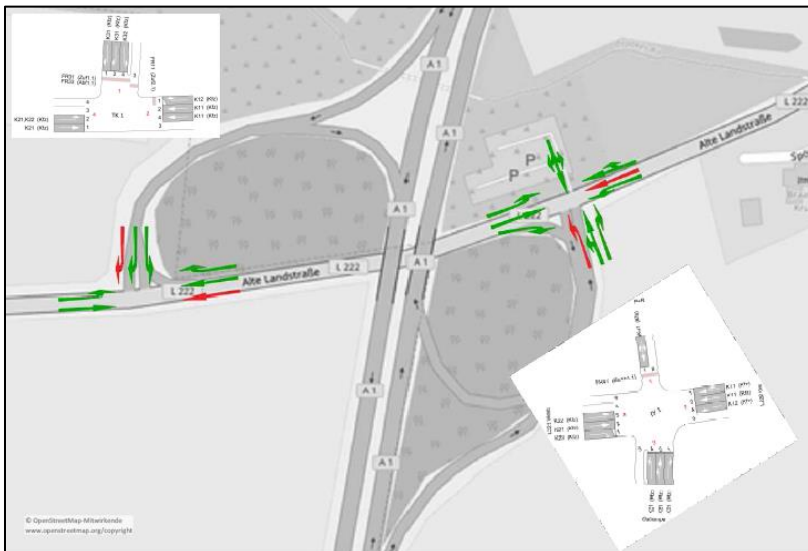
Abbildung 8: Struktur AS Stapelfeld mit Spurverdopplung nach Hamburg fahrend, Quelle: Verkehrskonzept M+O Ingenieurgesellschaft für das Bauwesen mbH
