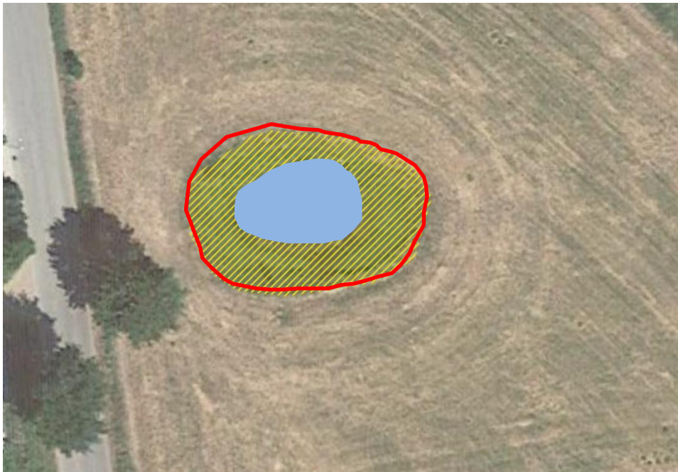
Abb. 3: Temporäres Kleingewässer. Der gelbe und der blaue Bereich werden ausgebaggert und mit Lehm verdichtet, so dass Wassertiefen bis 50 cm entstehen und eine längerfristige Wasserführung erzielt wird.
