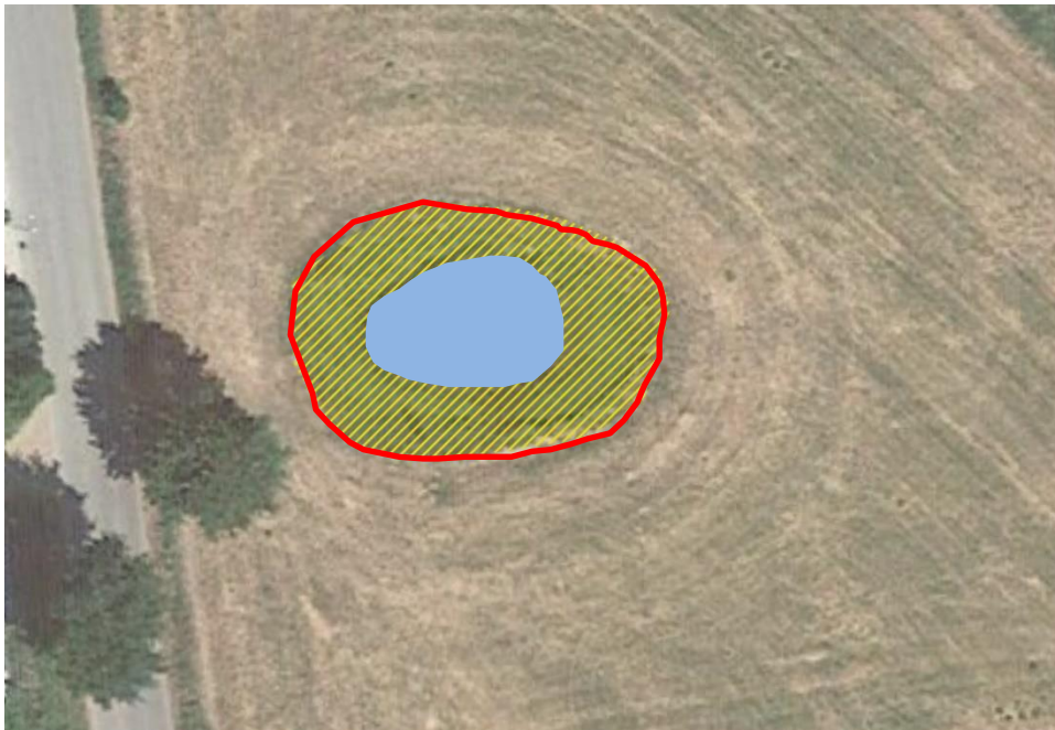
Abb. 5: Temporäres Kleingewässer. Der gelbe und der blaue Bereich werden ausgebaggert und mit Lehm verdichtet, so dass Wassertiefen bis 50 cm entstehen und eine längerfristige Wasserführung erzielt wird.
