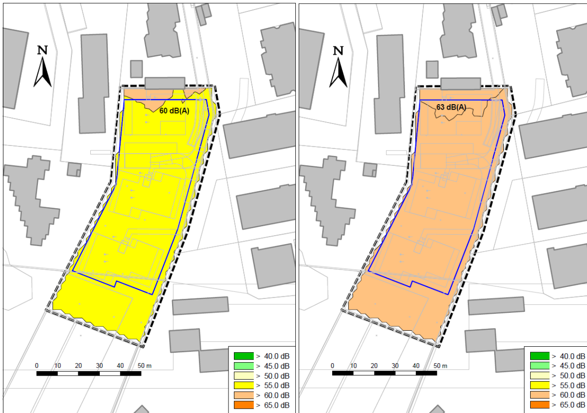
Abbildung 1: maßgeblicher Außenlärmpegel für schutzbedürftige Räume
