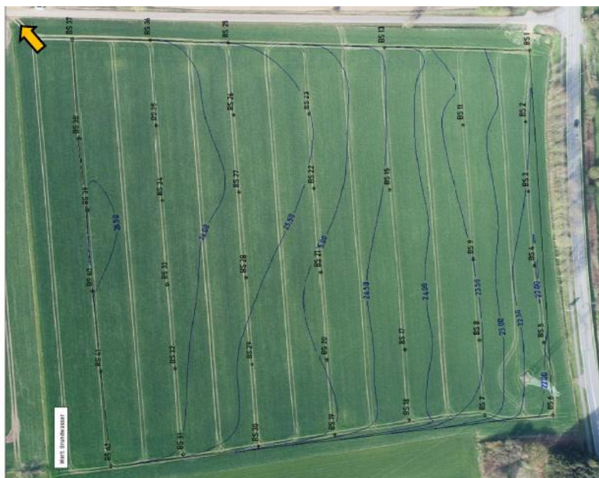
Abbildung 2: Grundwasserstände (Auszug Bodengutachten)
