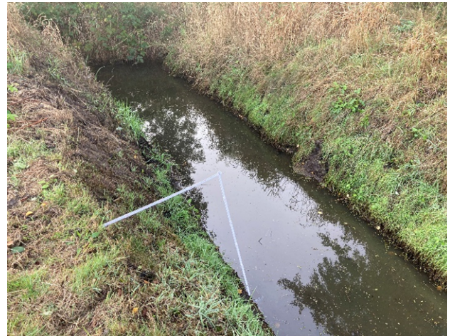
Abbildung 3: Wasserspiegelhöhe bezogen auf die Böschungsoberkante
