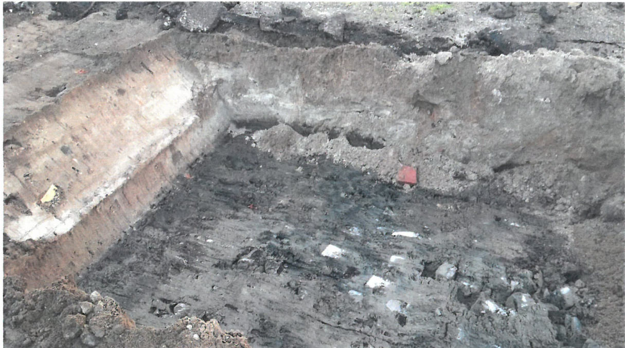
Foto 1: Baggerschurf am 15.11.18 im Bereich der BS 3, Tiefe ca. 1,0 m u.GOK
