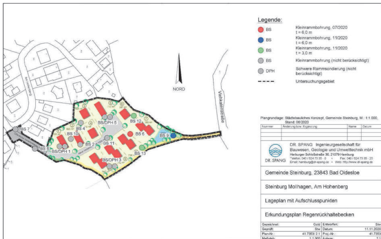
Abbildung 18: Lageplan mit Aufschlusspunkten – Erkundungsplan Regenrückhaltebecken (Dr. Spang Ingenieurgesellschaft für Bauwesen, Geologie und Umwelttechnik mbH)
