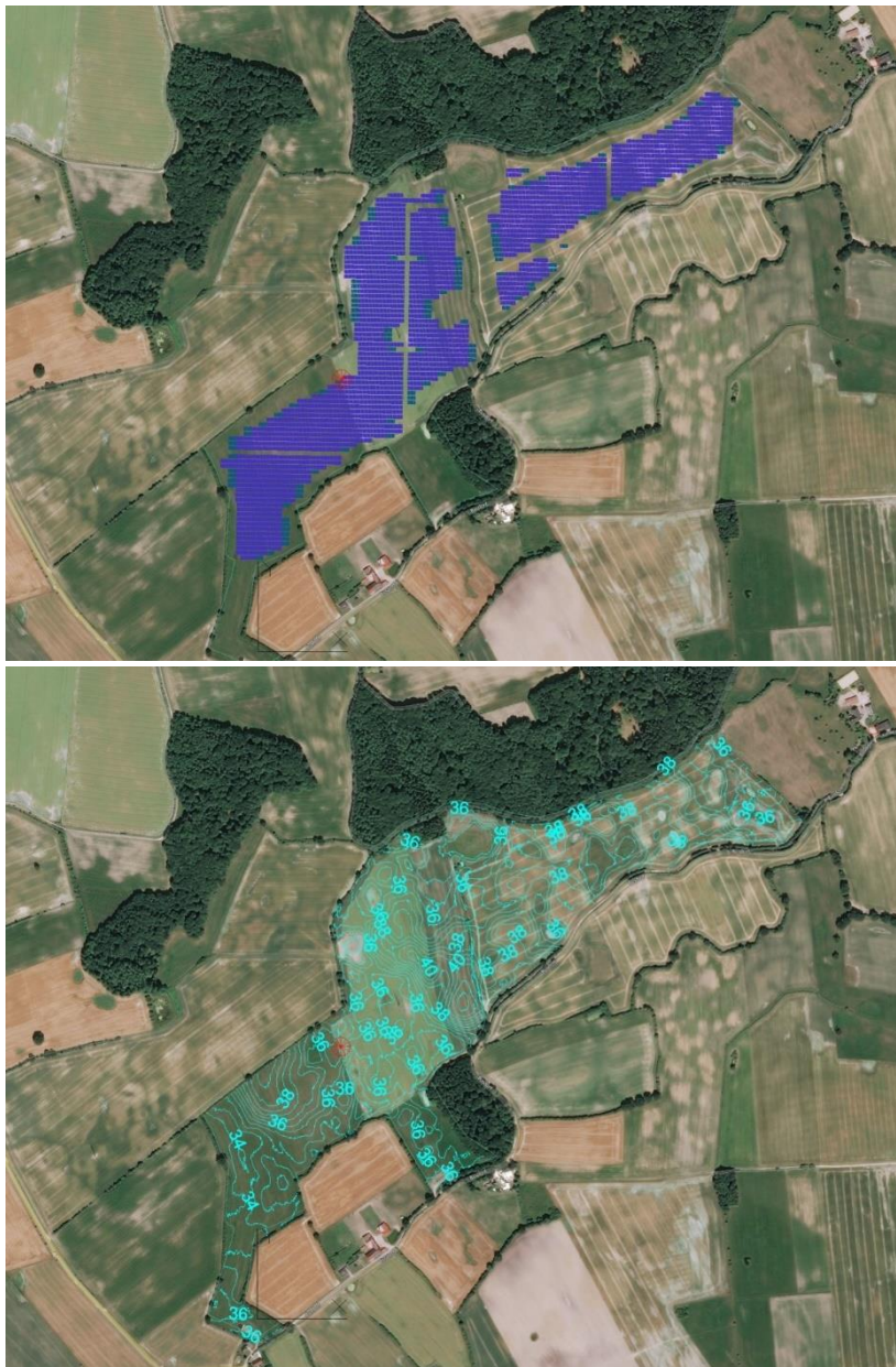
Abbildung 5: Lage der Tischreihen (oben) und die vermessenen Höhen (unten); Quelle. Kundenmaterial
