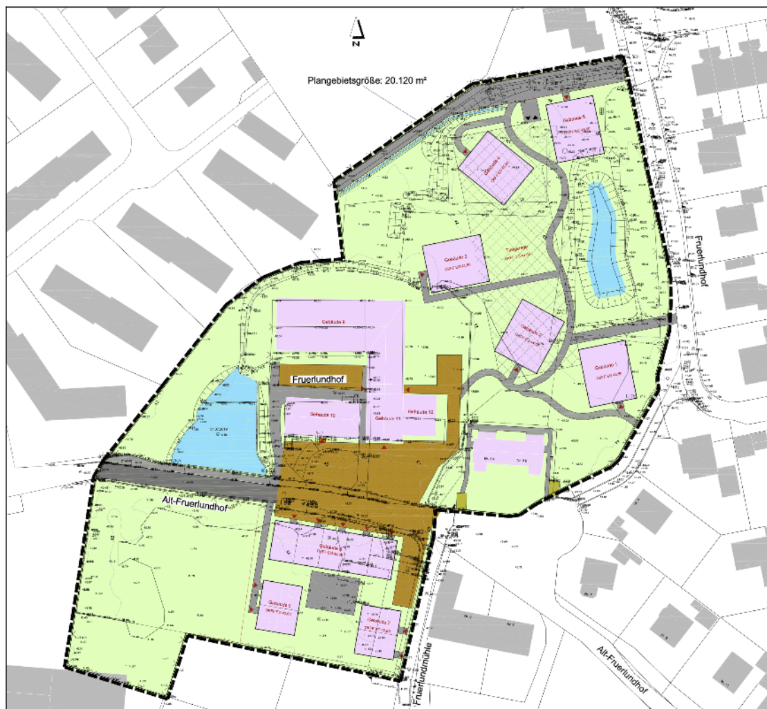
Abb.: Entwässerungskonzept (Haase + Reimer Ingenieure, 06.11.2020)
