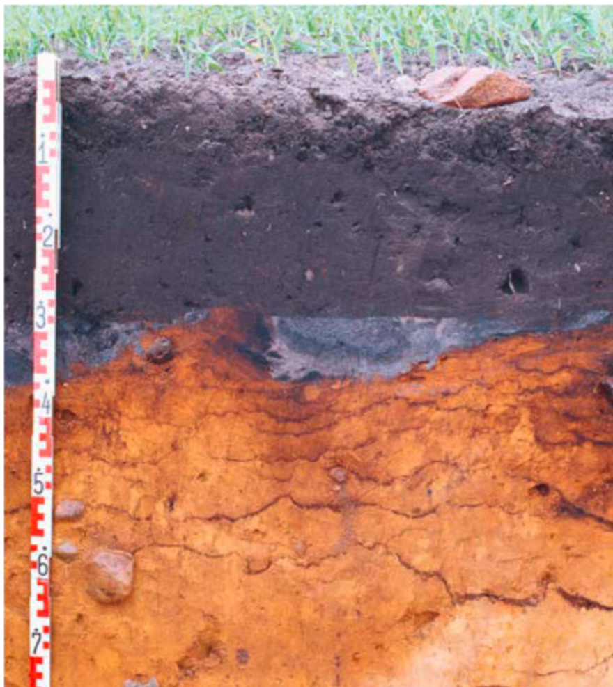
Abbildung 14 – Aufbau / Systemquerschnitt eines Podsol – Braunerde-Bodenprofils
