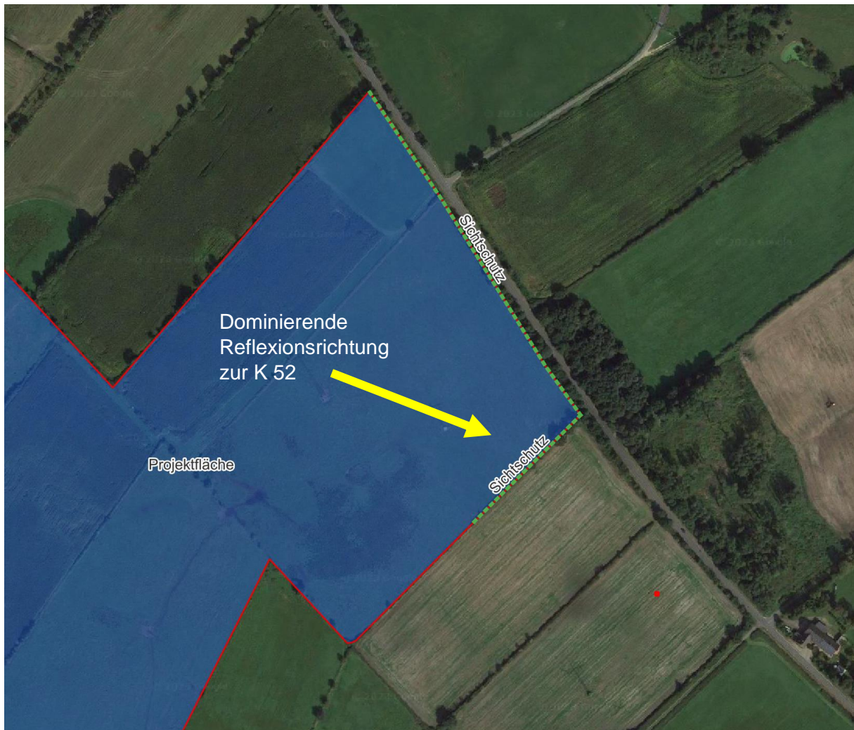
Abbildung 11: Empfohlene Position des Sichtschutzes und Darstellung der dominierenden Reflexionsrichtung - Quelle Satellitenbild: Google Earth Pro
